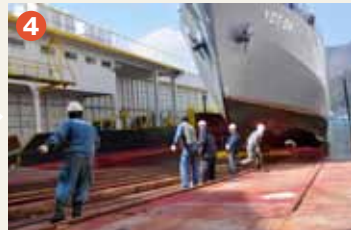
↑船を載せている船台の引き揚げ用ワイヤーを付け加え、補強しながら巻き上げる300トンの船だが作業は慎重
